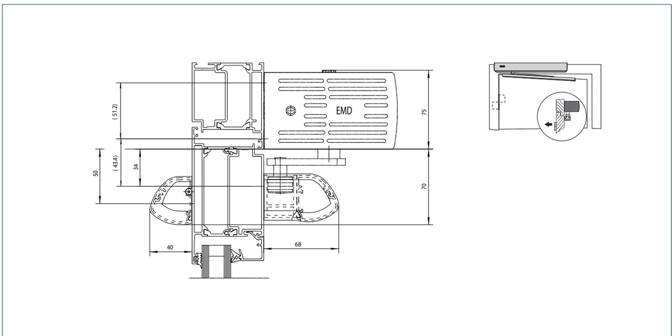
**GC GR (GC 338) 1200 MM MIT ROLLENSCHIENE, EINFLÜGELIG**
