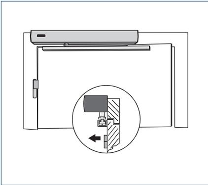
Kopfmontage mit Gleitschiene / Rollenschiene
