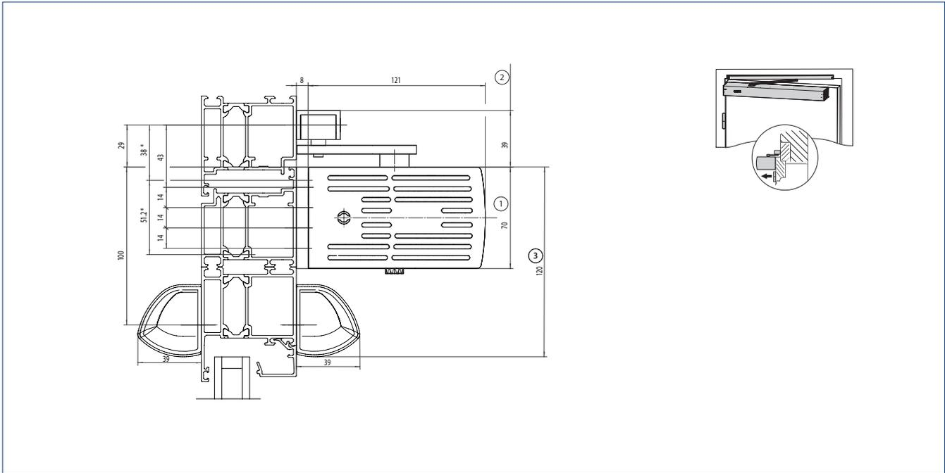
\* = Direktmontage | 1 = Platzbedarf EMD-F/EMD Invers | 2 = Platzbedarf Rollenschiene | 3 = Platzbedarf Sensorleisten
