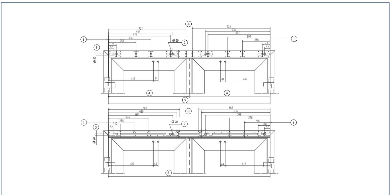
A = Montage mit Montageplatte | B = Direktmontage | 1 = Maßbezug Bandmitte | 2 = Verdeckte Kabelzuführung für Sensoren, Türöffner, Programmschalter und Riegelschaltkontakt | 3 = Verdeckte Kabelzuführung 230 V / 50 Hz | 4 = Türfügelbreite | 5 = Bandabstand
