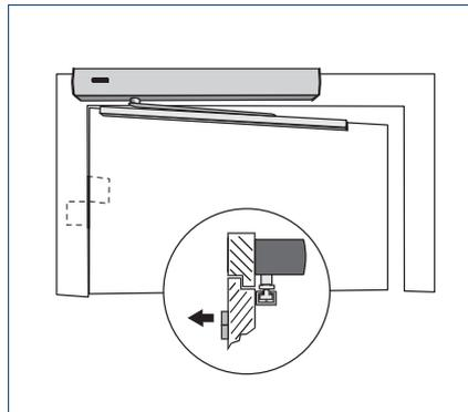
Kopfmontage mit Gleitschiene / Rollenschiene
