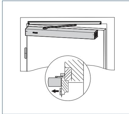
Türblattmontage mit Gleitschiene / Rollenschiene
