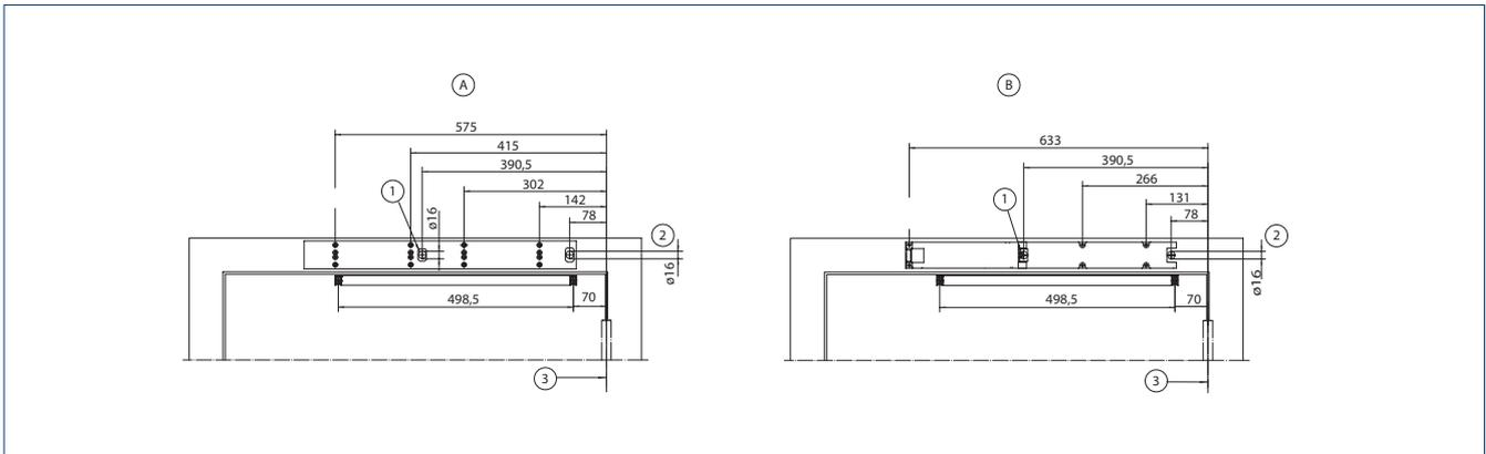
A = Montage mit Montageplatte | B = Direktmontage | 1 = Verdeckte Kabelzuführung für Niederspannungsanschluss | 2 = Verdeckte Kabelzuführung für Niederspannungsanschluss und Netzleitung | 3 = Maßbezug Bandmitte
