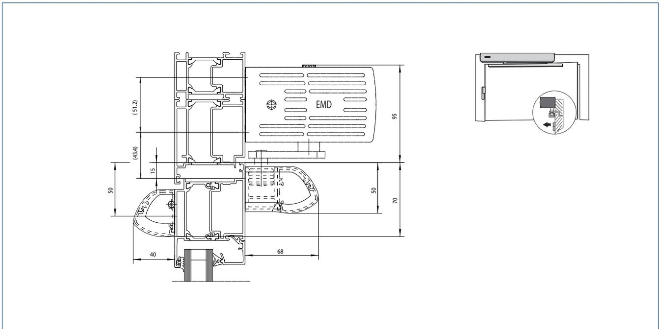
**EMD UND GC GR (GC 338) KOPFMONTAGE MIT ROLLENSCHIENE AUF DER BANDGEGENSEITE**
