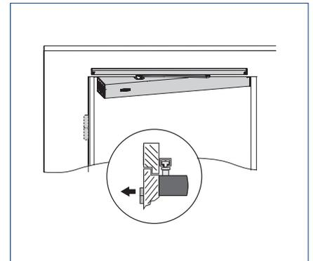
Türblattmontage mit Gleitschiene / Rollenschiene
