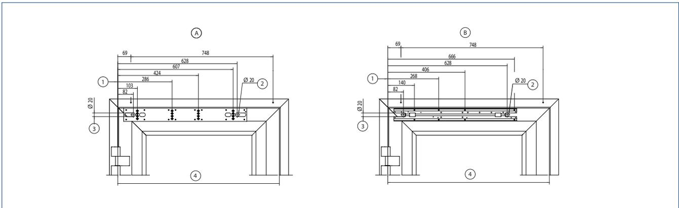
A = Montage mit Montageplatte | B = Direktmontage | 1 = Maßbezug Bandmitte | 2 = Verdeckte Kabelzuführung für Sensoren, Türöffner, Programmschalter und Riegelschaltkontakt | 3 = Verdeckte Kabelzuführung 230 V / 50 Hz | 4 = Türflügelbreite
