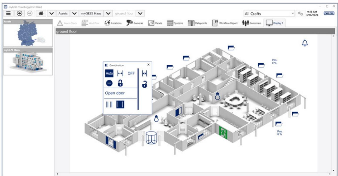
Gebäudemanagement-Software zur Visualisierung, Bedienung, Steuerung und Überwachung von angebundenen GEZE-Produktsystemen
