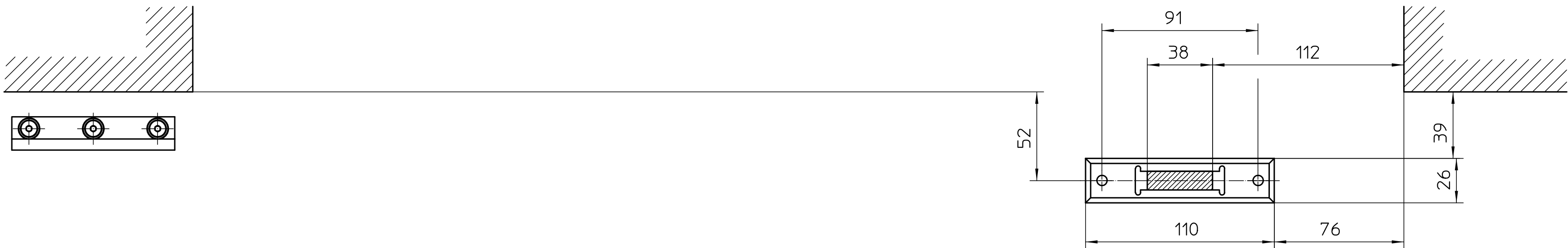
H: Bodenschloß, Winkelbodenführung, rechts schließend H: Floor lock, angular floor guide, right closing
