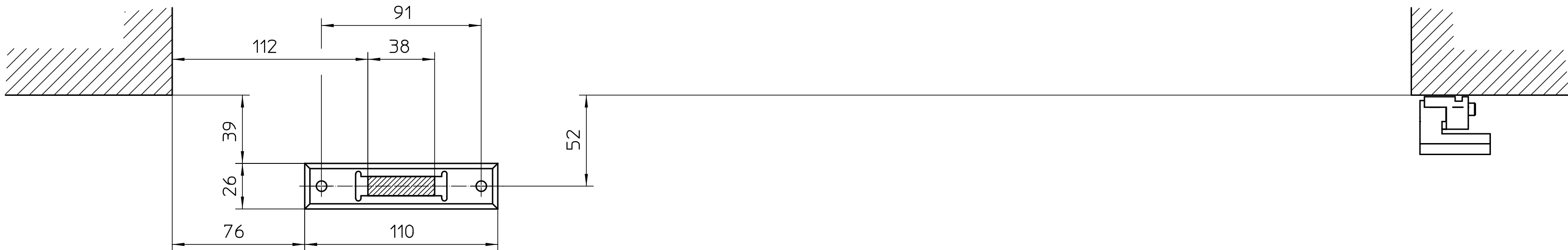
H: Bodenschloß, Verstellbare Bodenführung, links schließend H: Floor lock, adjustable floor guide, right closing
