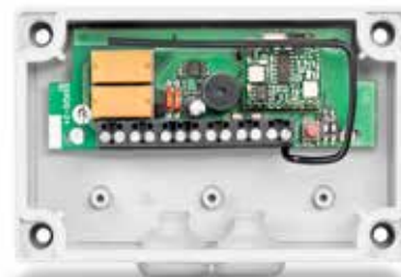
WRM-24B radiomodtagemodul i IP-54-kabinet
