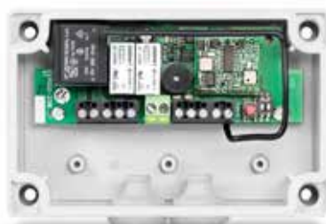
WRM-230B radiomodtagemodul i IP-54-kabinet
