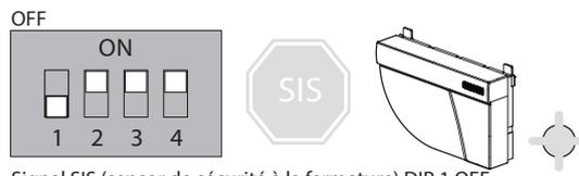
Signal SIS (sensor de sécurité à la fermeture) DIP 1 OFF
