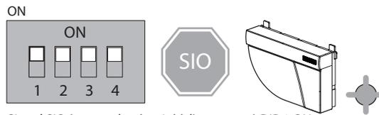
Signal SIO (sensor de sécurité à l'ouverture) DIP 1 ON
